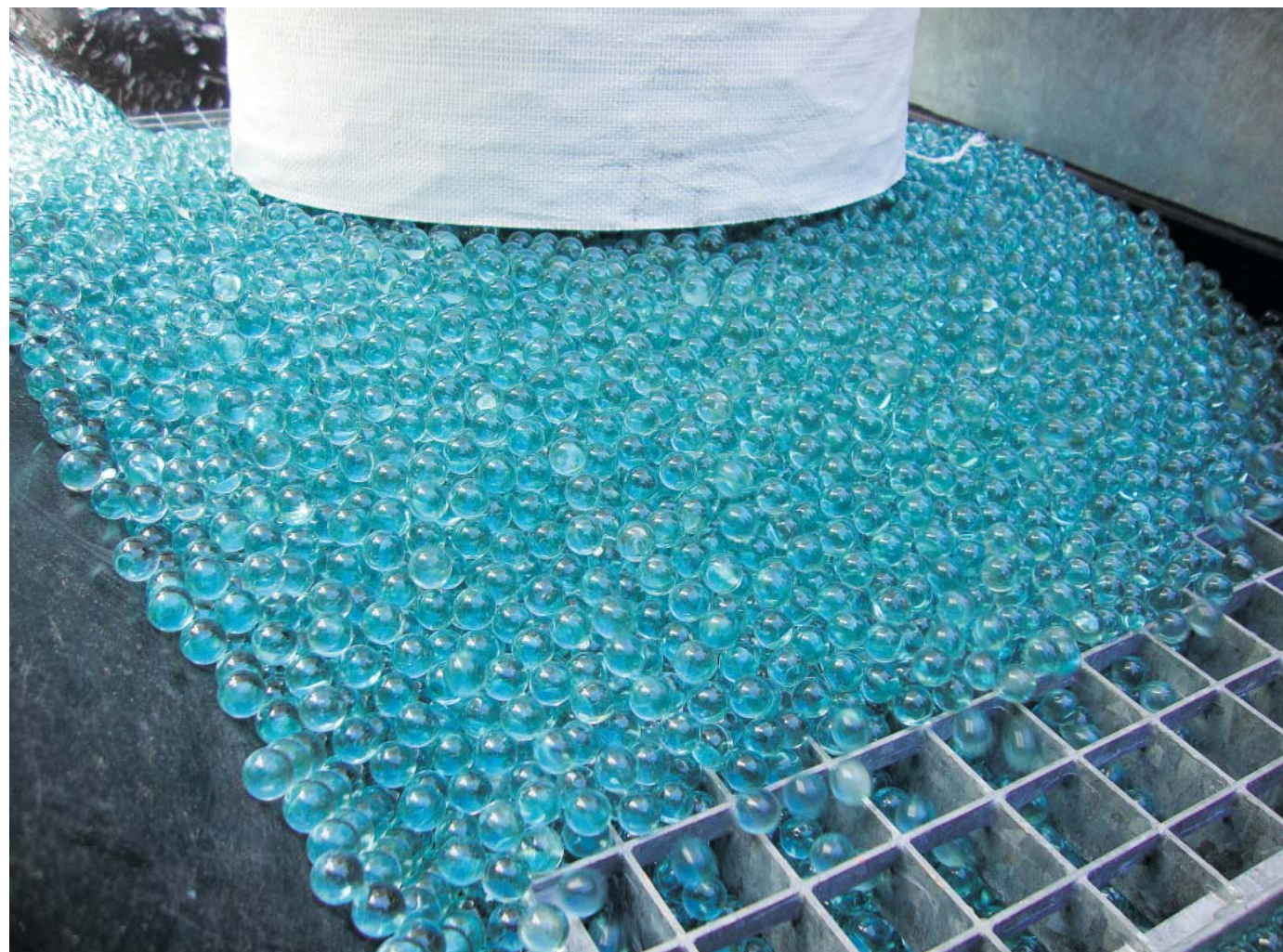
Schütt gut: Besser als der übliche Kies helfen Glaskügelchen gegen die Verstopfung von Trinkwasserbrunnen
