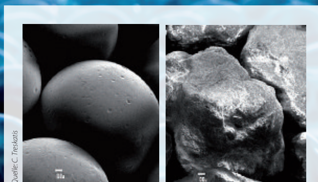
Abb. 2 REM-Aufnahme einer Glaskugel im Vergleich zum einem Filterkieskorn gleicher Korngröße. Die „glatte“ Oberfläche der Glaskugel verhindert die Bildung von Zugspannungen bei Lastaufgabe und mindert die Anlagerung von Inkrustationen.
