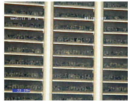
Abb. 4 Mit Glaskugelschüttung und Wickeldrahtfilter ausgebauter Brunnen
