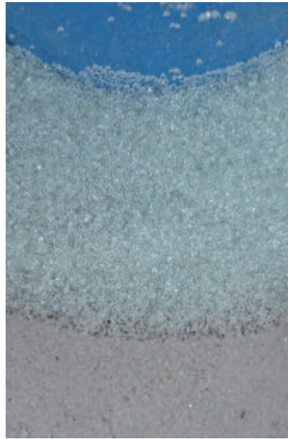
Abb. 10: Kontaktbereich Glaskugeln zum Boden im Versuch 1 (Kugeldurchmesser 1,7 bis 2,1 mm)
