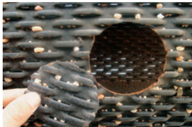
Abb. 4 Durch Unterkorn kolmatierter Schlitzbrückenfilter (aus aufgelassenem Brunnen)
