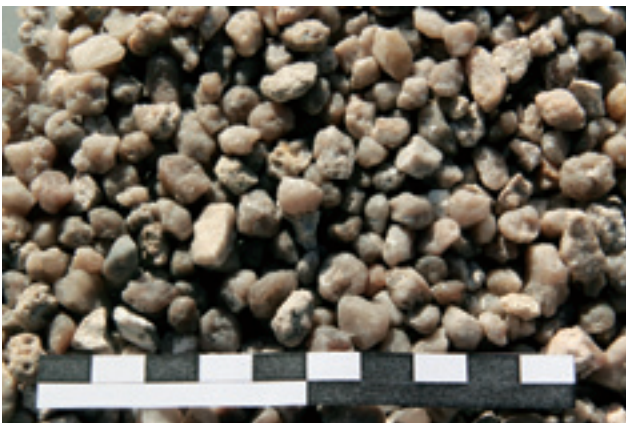
Abb. 1 Quarkies, Körnung 5,6 bis 8,0 Millimeter gemäß DIN 4924
