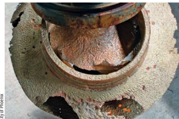
Abb. 1 – Durch Sandführung zerstörtes Pumpenlaufrad
